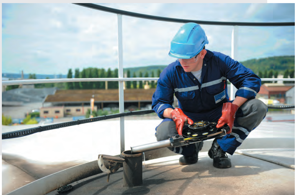
Contrôle du niveau d'un bac avec jaugeur manuel à ruban en tenue de protection obligatoire.
